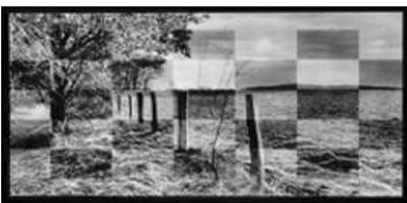
图 1 OLED 显示器的残影现象
