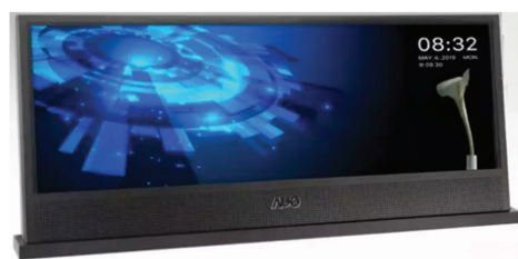
图 12 运用纳米压印技术制作的 39.62 cm(15.6 in) 镜面显示器
