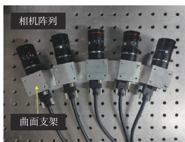
图 9 复眼相机阵列的实验装置
