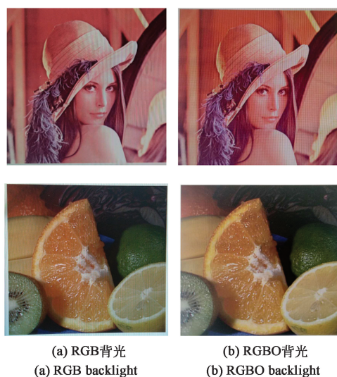
图 20 两种背光的液晶显示器显示的图像 Fig.20 Images displayed by two backlight LCD
