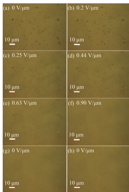
图 7 碳纳米管聚集体随电场强度的变化 [36]
