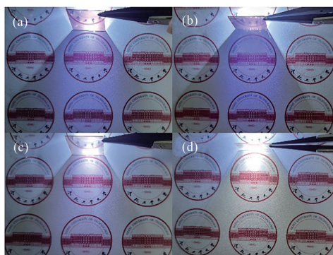
图 5 纳米颗粒样品在含有大量蓝光的普通白色 LED 下透光效果。Au@Ag NPs(a) 和 Ag NPs(b) 自组装未退火实际透光效果; Au@Ag NPs(c) 和 Ag NPs(d) 自组装退火实际透光效果。
