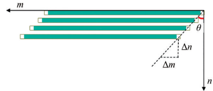
图3 子图像阵列几何关系示意图 Fig. 3 Geometrical relationship of sub-image array processing
