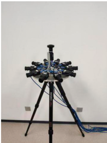
图 1 全景相机侧面及顶部成像部分
