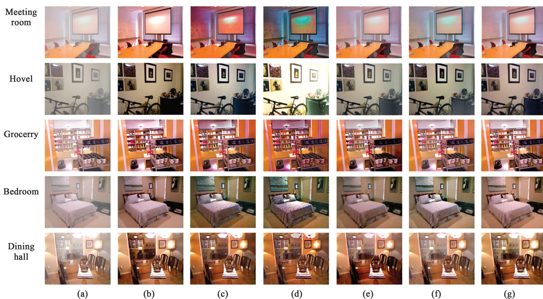
图 4 合成有雾图像结果对比。(a)雾天图像;(b)原始图像;(c)DCP;(d)BCCR;(e)DehazeNet;(f)MSCNN;(g)本文算法。
