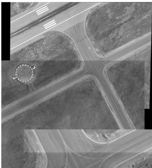
图 5 经模板匹配算法处理后的拼接图像 Fig. 5 Stitching images by template matching algorithm
