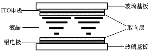
图 1 液晶盒的结构
