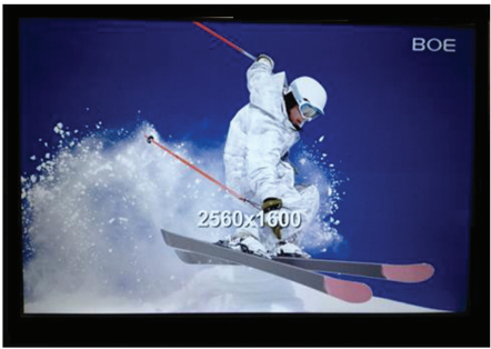
图 9 BOA 原型机显示画面 Fig. 9 Display image of 10.1 in WQXGA prototype
