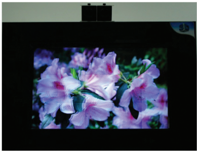
图 3 时空混合控制式自由立体显示样机 Fig. 3 Prototype of auto-stereoscopic display with SSHC
