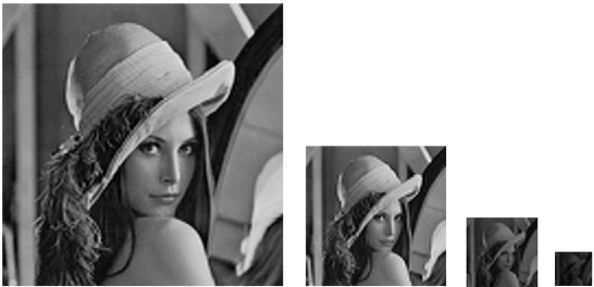
图 4 图像四级小波分解低频子图像 Fig. 4 Four-scale wavelet transform of LL
