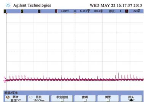
图 6 普通驱动方法接收电路输出信号波形图
