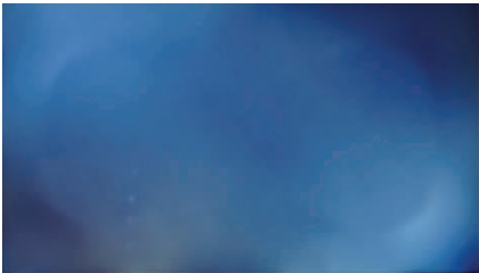
图 3 Egg Mura 现象图片 Fig. 3 Egg Mura phenomenon picture
