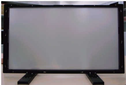
图 6 81 cm(32 in)背光模组样品 Fig. 6 Sample of backlight module
