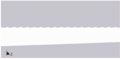
图 5 导光板底部微型结构放大图
