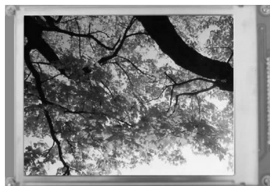
Fig. 4 液晶屏显示图像测试结果
