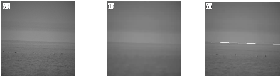
图 9 (a) 天空和海面分层且有物体噪声的图像;(b) 中值滤波结果;(c) 海天线未受分层干扰.
