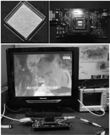
图 5 定标器芯片测试平台
