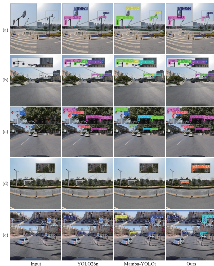
图 5 TT100K 数据集上的交通标志检测结果。(a) 倾斜视角; (b) 逆光环境; (c) 阴影干扰; (d) 目标遮挡; (e) 常规环境。 Fig. 5 Traffic sign detection results on the TT100K dataset. (a) Oblique views; (b) Backlit scenes; (c) Shadow disturbances; (d) Object occlusions; (e) Normal scenes.
