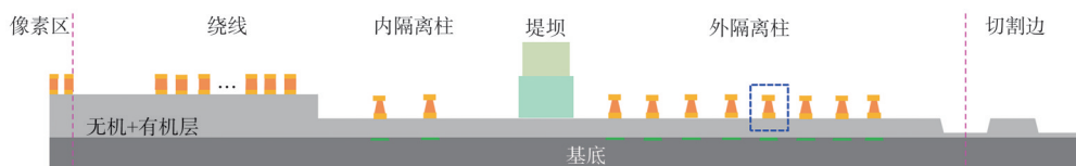
图3 挖孔屏孔区隔断示意图
