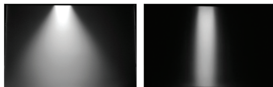
图 10 导光板出光面无结构(左)和加结构(右)测试图
