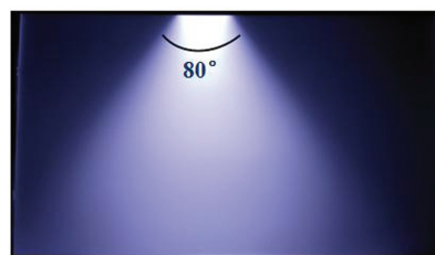
图 2 导光板出光面光线分布
