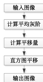
图 2 基于直方图平移的色彩还原算法
