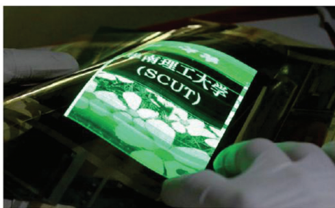
图 16 溶液法阳极氧化 \text{AlO}_x 栅极绝缘层的 PEN 基板的 AMOLED 器件 [46]
