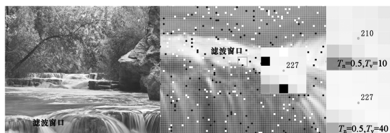
图4 边缘部位像素的椒盐噪声检测案例(“I03”)
