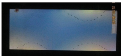
图 1 L0 漏光实物现象
