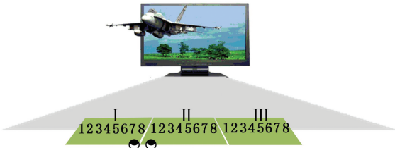
图 3 光栅 3D 显示器视区分布示意图 Fig.3 View area of three-dimension lenticular display
