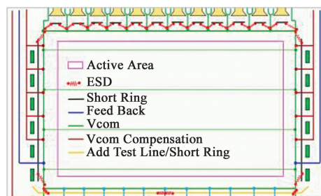
图 3 带有公共电极电压补偿线路的 TFT 版图设计示意图
