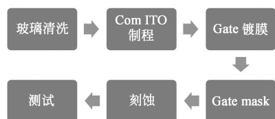
图 1 实验样品工艺流程
