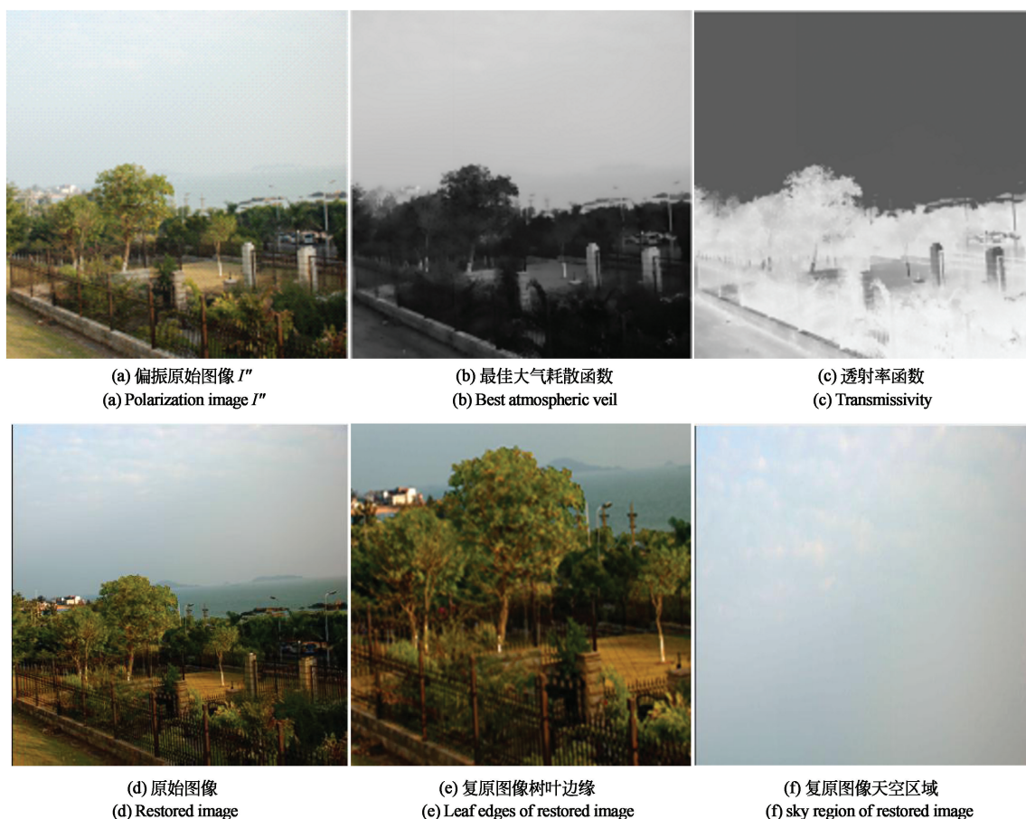
图 5 改进算法最佳大气耗散函数结果及克服 Halo 效应结果示意图
