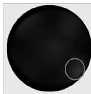
图 6 实测获得补偿的 IPS-LCD 在黑态的亮度表现,其中复合补偿膜的 R_e = 147 \text{ nm} , R_{th} = 60 \text{ nm}
