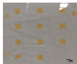
图 12 量子点光刻胶光刻工艺后的图案
