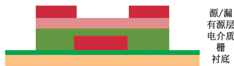
图 1 钆铝锌氧薄膜晶体管结构图
