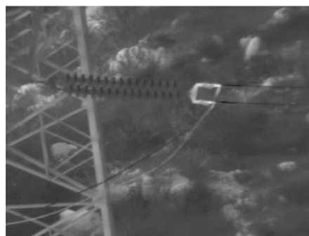
图 10 含有故障跳线联板红外图像
