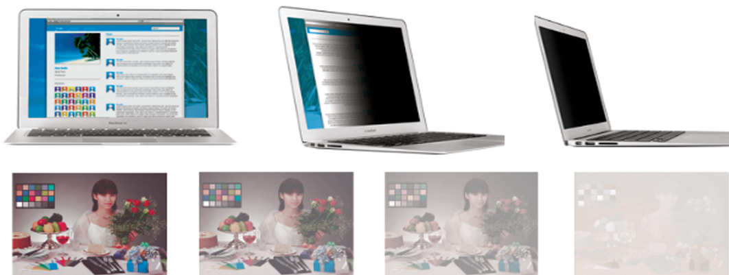
图 5 贴附 3M 公司保护膜的窄视角显示的图片(顶部三张图片);本文提出的窄视角液晶显示器显示的图片(底部四张图片从左到右依次为 0、20、30、40° 度极角的观看图)
