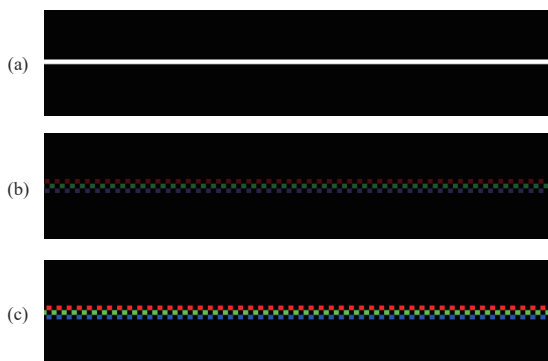
图 6 单线宽黑底白线渲染。(a) 原图;(b) 不加权平均算法渲染效果;(c) 自适应权重算法渲染效果。
